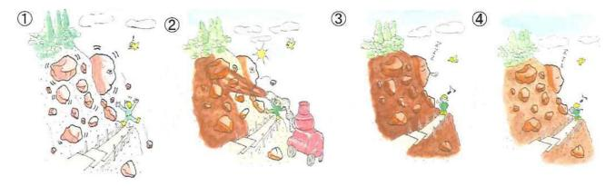
砂防堰堤や土留工等では、表面侵食による落石が発生しやすい斜面を背に作業を実施しなければならない場合があります。このような場合、事前に仮設ECOバインド工法を実施することで、背面の安全性を向上させることが可能です。これにより背面の侵食は抑制され、本施工を安心して施工できます。
