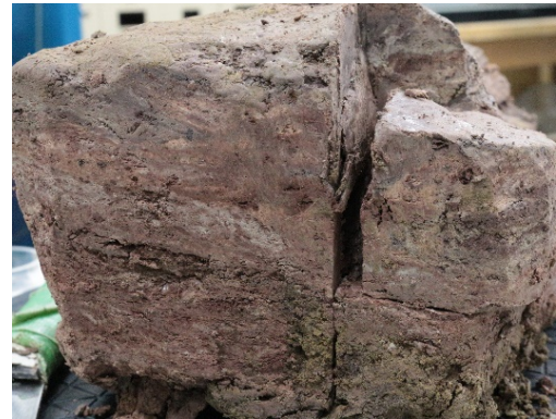
すべり面の確認（灰色の薄い粘土層）
